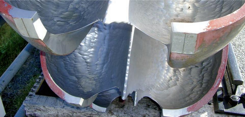
Verschleißteile in einem Wasserkraftwerk können durch Kleinstpartikel beschädigt werden.
