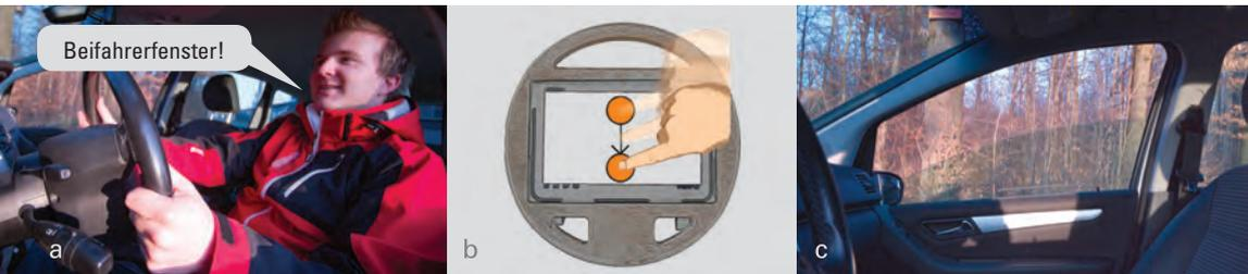
Vereinfachter Ablauf für ein System zur multimodalen Interaktion: Das Lenkrad als zentrales Bedienelement wird interaktiv und erlaubt dem Benutzer, Funktionen über Sprache und Zeigegesten multimodal zu bedienen. Hier ein Beispiel: (a) der Fahrer wählt das Fensteröffnen zuerst per Sprache aus, (b) um dann über eine Zeigegeste auf dem Multitouch-Lenkrad (c) das Fenster zu öffnen.
