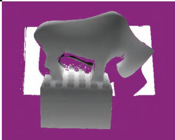
Eine Tiefenkarte der Rekonstruktion. Die Farbe der Pixel kodiert die Entfernung zu der Kamera: weiße Pixel sind weiter entfernt von der Kamera, schwarze weniger.
