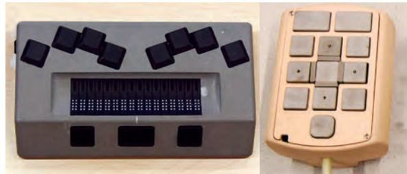
Rechts: Braillezeile für den mobilen Einsatz. Die leicht nach außen gedrehte Tastatur lässt sich bequem vor dem Körper bedienen. Links: Hardwareinterface mit adaptiven, haptischen Stellteilen, speziell für die Mehrzahl der Nicht-Braille-Leser entwickelt.
