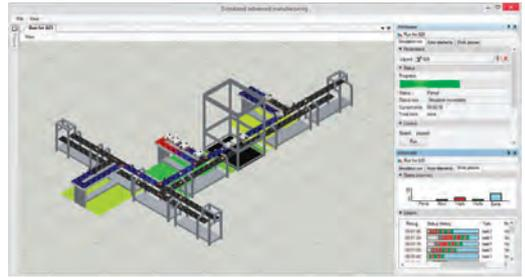
Das Visual-Analytics-System zur Layoutplanung für flexible Fertigungssysteme visualisiert durch Simulation gewonnene Kennwerte zu Werkstückdichten und Auslastungen.
