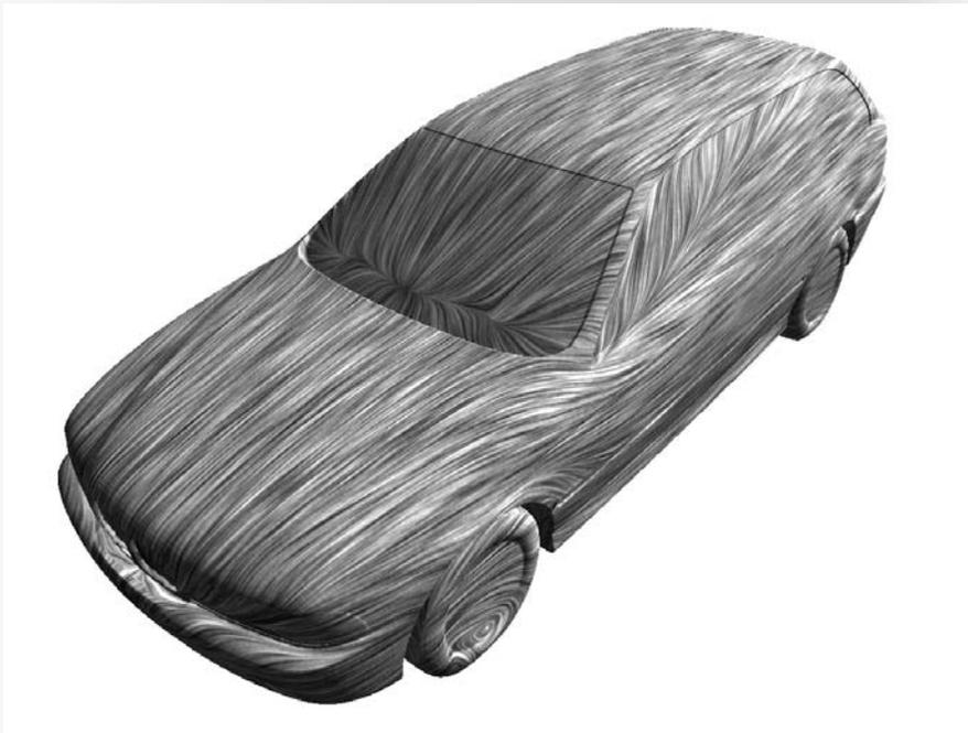
**Abb. 2.2:** Texturbasierte Strömungsvisualisierung auf gekrümmten Oberflächen.
