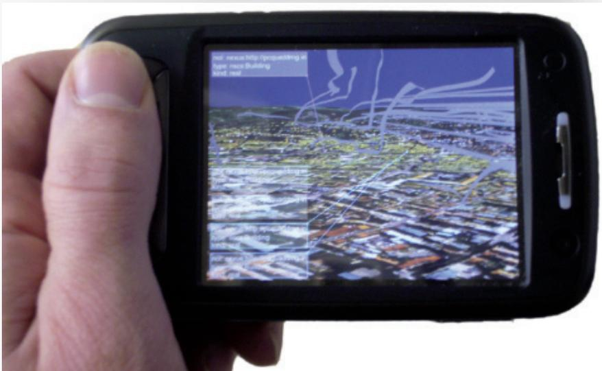
**Abb. 2.4:** Ubiquitäre Visualisierung auf einem mobilen Gerät. In diesem Beispiel wird ein 3D-Höhenfeld gemeinsam mit der Strömungsvisualisierung durch Strombänder gezeigt. [Quelle: M. Eissele, D. Weiskopf, T. Ertl. Interactive Context-Aware Visualization for Mobile Devices. Proceedings of Smart Graphics 2009, 167-178, 2009]
