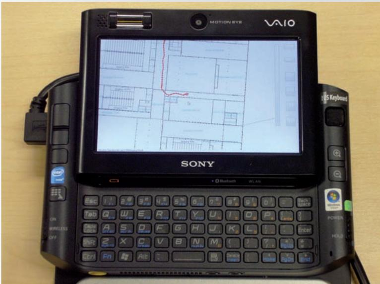
**Abb. 3.20:** Das Assistenzsystem TANIA ermöglicht eine schrittgenaue Positionsbestimmung unter Verwendung eines Inertialsensors und genauem Kartenmaterial mit ortsbezogenen Beschreibungstexten. Auf dieser Basis können blinde und sehbehinderte Benutzer des Systems auch innerhalb der komplexen Gebäude der Universität zu gewählten Zielorten geführt und akustisch oder in Braille über Bereiche und Objekte in der Umgebung informiert werden.
